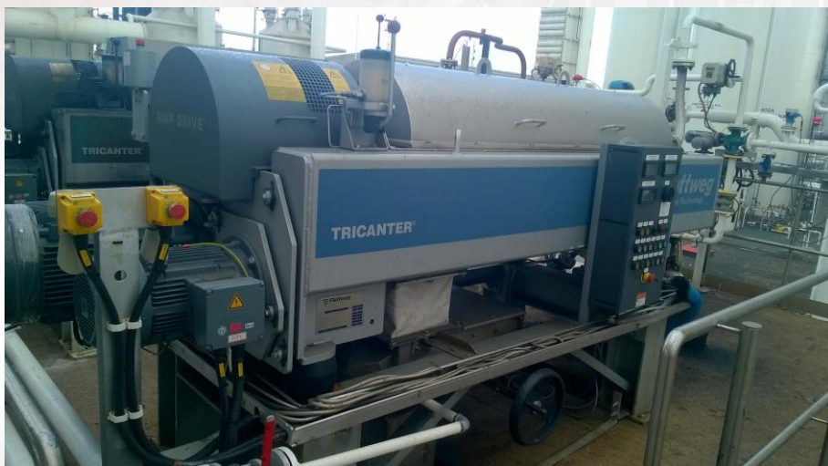
Zabudowa wirówki w instalacji oczyszczania wody amoniakalnej ze smoły
